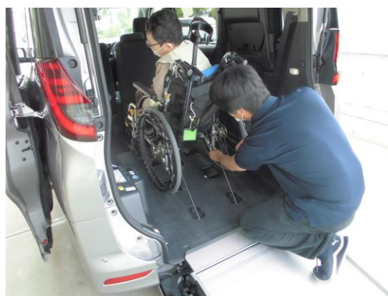
車いす固定の様子
